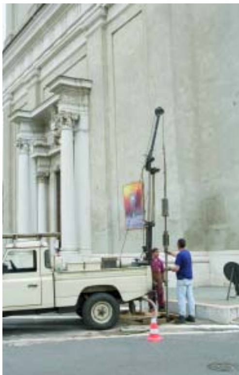
Una postazione per l'indagine penetrometrica dinamica SCPT.
